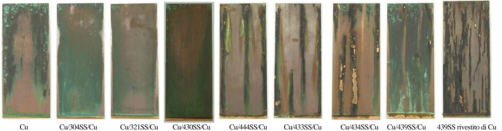
Figura 4: Campioni sottoposti a 1000 ore di spruzzo di sale ASTM B117.
